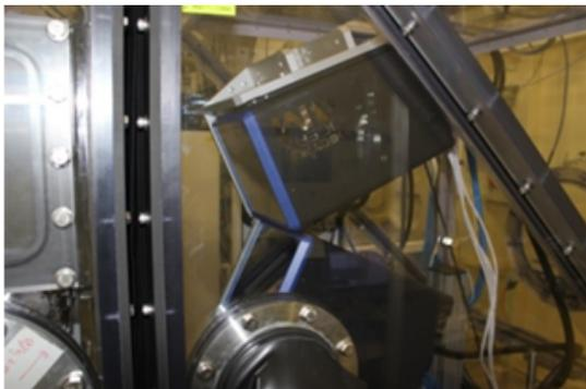
試料部とともにヘリウム環境下に置かれた2台のピクセルアレイ型検出器による高速・高分解能回折データ測定(PF BL-1A)
